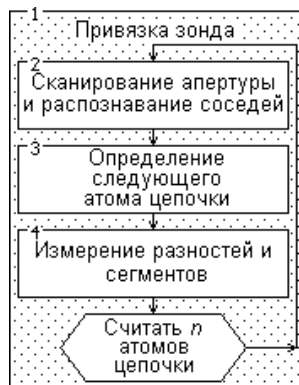
Рис. 2 Упрощённая блок-схема алгоритма. Процедура привязки зонда работает в фоновом режиме. Сканирование считается законченным, если длина цепочки достигла заданного значения n .
